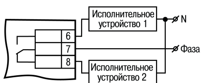
Рисунок 5.7 – Схема подключения нагрузки к ВУ типа «Р»
