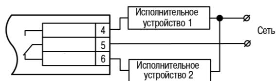
Рисунок 12 – Схема подключения нагрузки к ВУ типа Р
