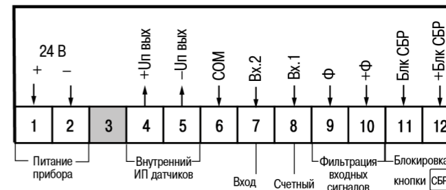
Рисунок 5.1 – Назначение контактов клеммника
