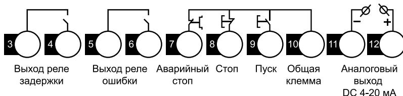
Устройство плавного пуска имеет 3 непрограммируемых входа дистанционного управления. Эти входы могут быть подключены в разных вариациях управления согласно представленным ниже схемам:
