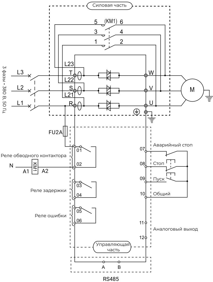
Схема подключения со встроенным обводным контактором для серии SBI
