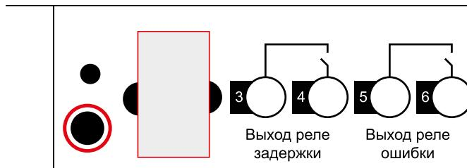
С помощью плоской шлицевой отвертки откалибруйте показания тока на дисплее с помощью винта на регулировочном потенциометре (см. выделенную область на рисунке выше). При вращении по часовой стрелке происходит уменьшение показаний, при вращении против часовой – увеличение показаний. При достижении оптимальной точности верните наклейку в исходное положение. Дальнейшие работы производить в штатном порядке.
