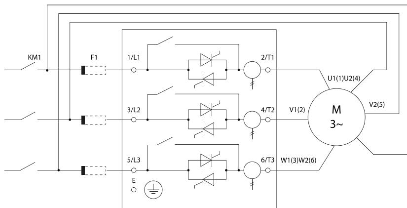
KM1 - сетевой контактор, F1 - плавкие предохранители.
