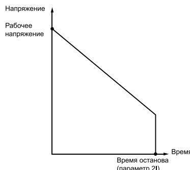
При достижении нулевого значения вал двигателя может вращаться из-за остаточной механической инерции. Данный режим используется в случаях, например, когда необходимо увеличить время останова для плавного снятия нагрузки с питающего генератора.
