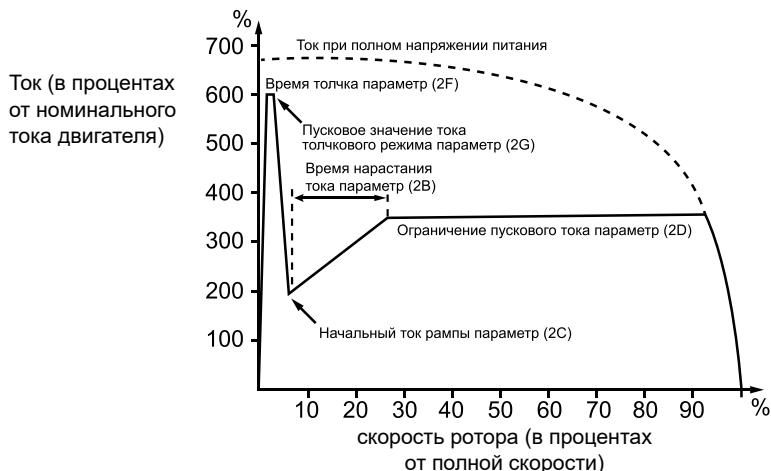
В режиме запуска с рывком осуществляется кратковременная подача токового импульса с заданным ограничением, этот режим позволяет повысить пусковой момент в случаях, когда для нагрузки необходим тяжелый запуск и впоследствии легкий разгон. Данный режим может использоваться совместно с рампой по току и режимом ограничения пускового тока.
