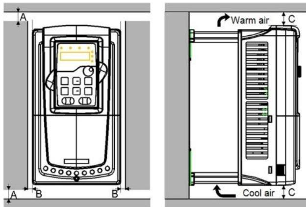
Рисунок 4-16. Вентиляционные промежутки
