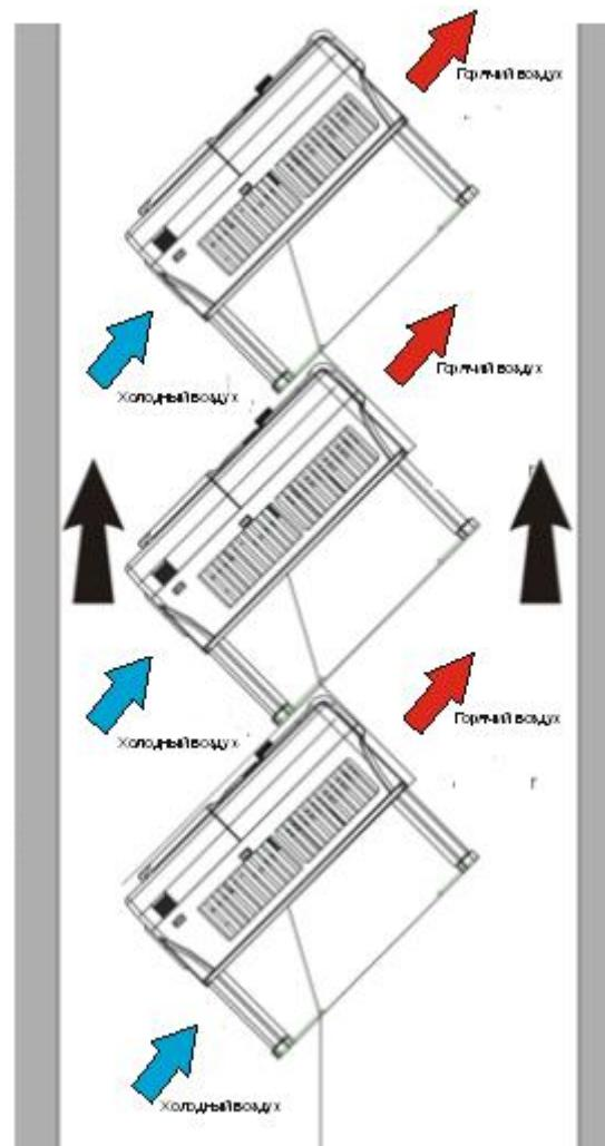
Рис. 4-5 Наклонная установка
