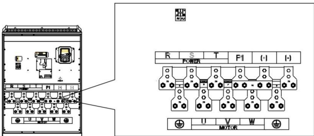
Рис. 5-12 Клеммы силовых цепей 220 – 315 кВт
