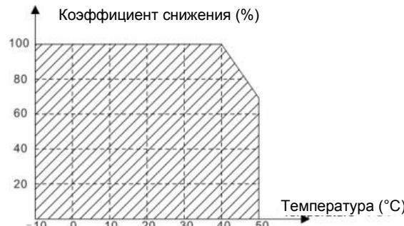
Рисунок 3-2. Снижение номинальной мощности ПЧ.
