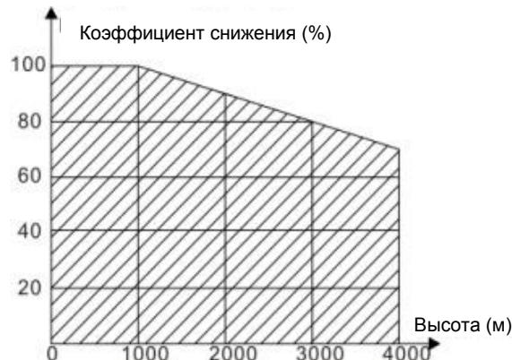
Рисунок 3-3. Снижение номинальной мощности ПЧ.
