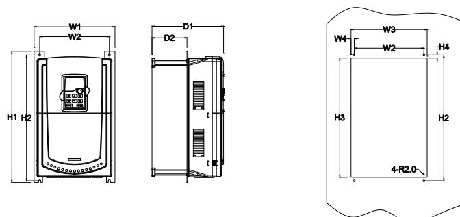
Рис. 4.10 Фланцевый монтаж 0.75 – 30 кВт
