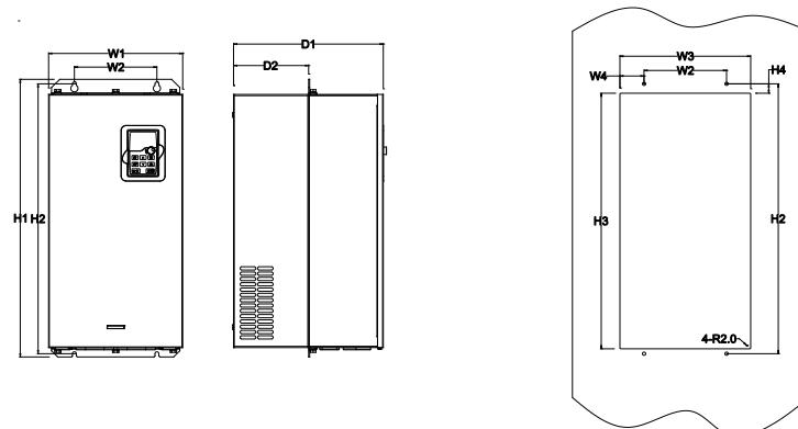
Рис. 4.11 Фланцевый монтаж 37 – 110 кВт
