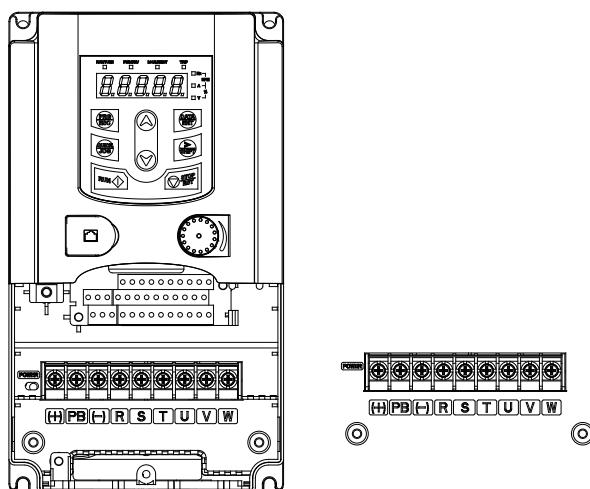
Рис. 5-5 Клеммы силовых цепей 4 – 5.5 кВт
