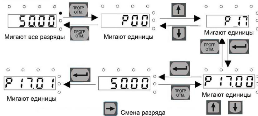
Рис. 6-5 Схема контроля состояния
