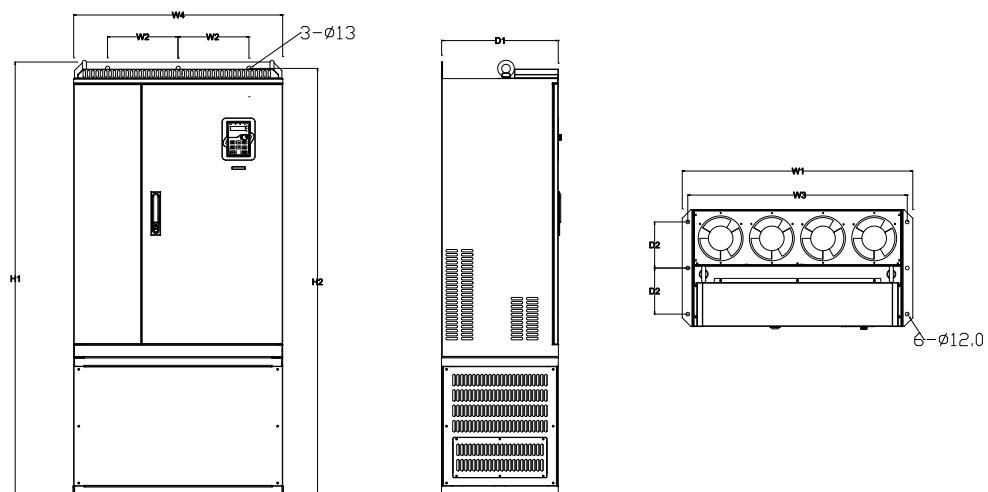
Рис. 4.13 Напольный монтаж 220 – 315 кВт
