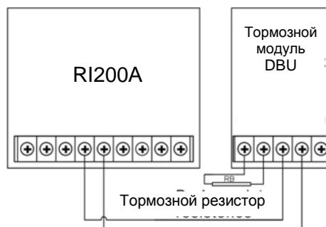
Рис. 12-6. Схема подключения модуля DBU и тормозного резистора
