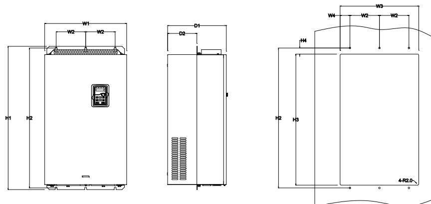
Рис. 4.12 Фланцевый монтаж 132 – 200 кВт
