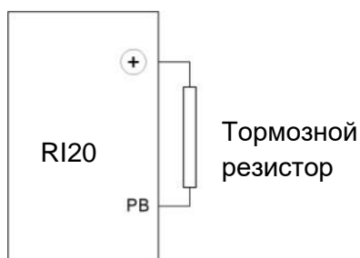
Рис. 12-3. Схема подключения тормозного резистора
