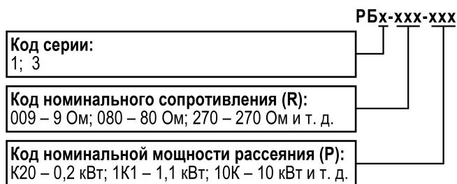
Резистор представляет собой керамический каркас с намоткой проволоки с высоким удельным сопротивлением, механической стойкостью и стабильностью параметров при перегреве. Выпускаются в открытом (РБ1) и защищенном (РБ3) исполнениях корпуса.
