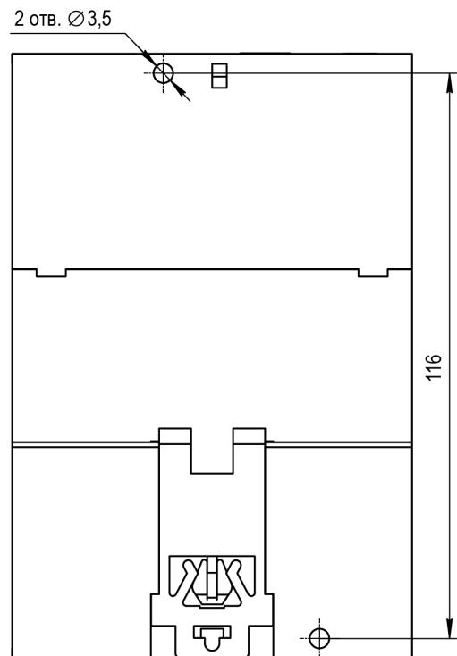
Рисунок 4.4 – Установочные размеры
