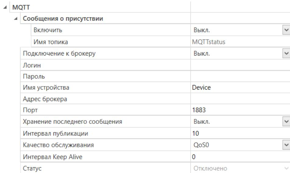
**Рисунок 7.6 – Параметры обмена по MQTT**
