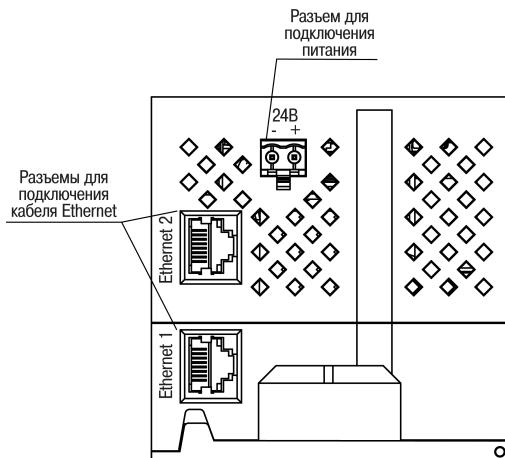
**Рисунок 5.2 – Разъемы прибора**
