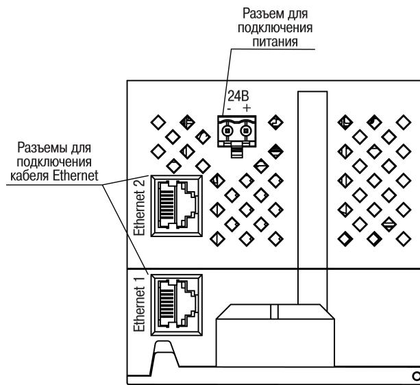
**Рисунок 5.2 – Разъемы прибора**
