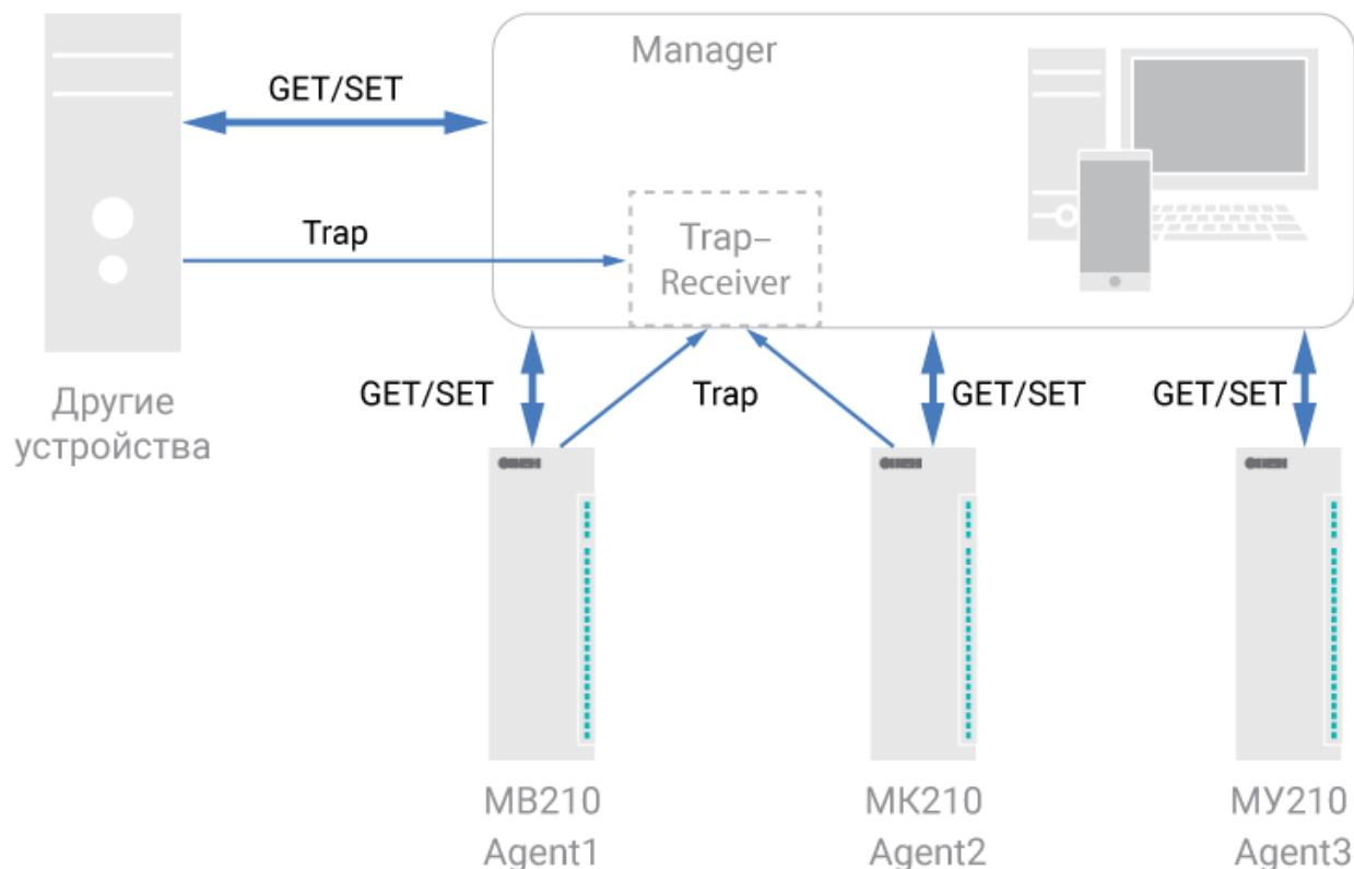
Рисунок 6.3 – Структурная схема обмена по протоколу SNMP
