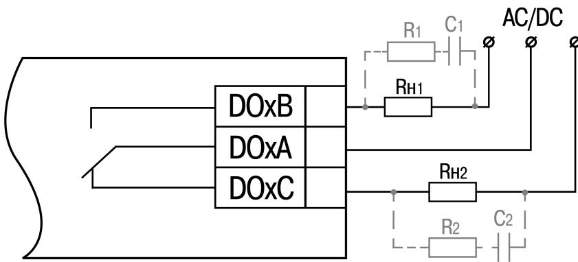
**Рисунок 5.4 – Схема подключения внешних связей к дискретным выходам с 1 по 4, с 13 по 16 с C/O контактами.**
