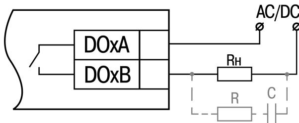
**Рисунок 5.5 – Схема подключения внешних связей к дискретным выходам с 5 по 12 с NO контактами.**
