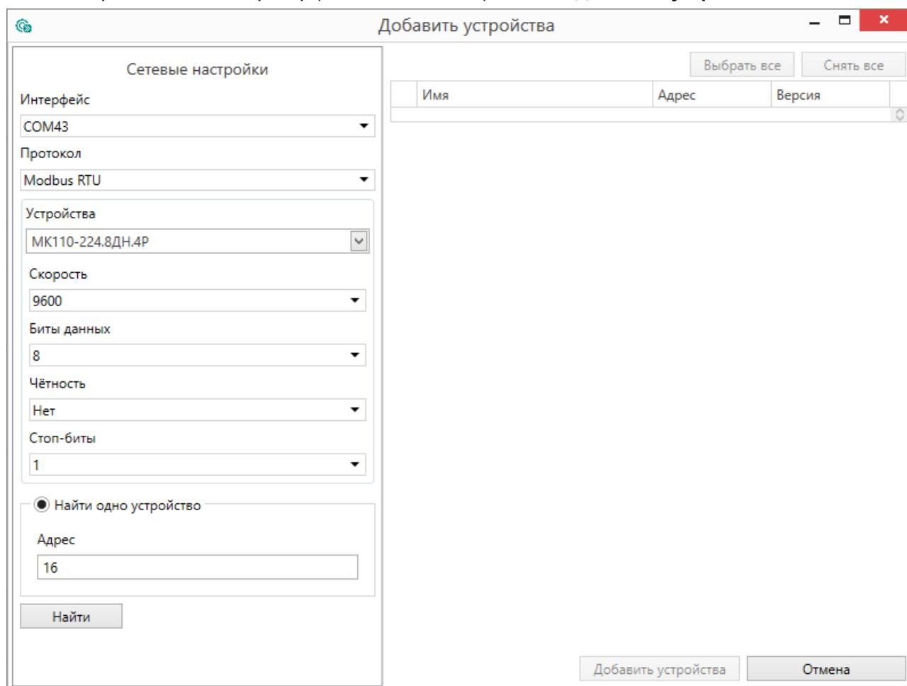
Рисунок 7.1 – Настройка сетевых параметров в ПО OWEN Configurator
