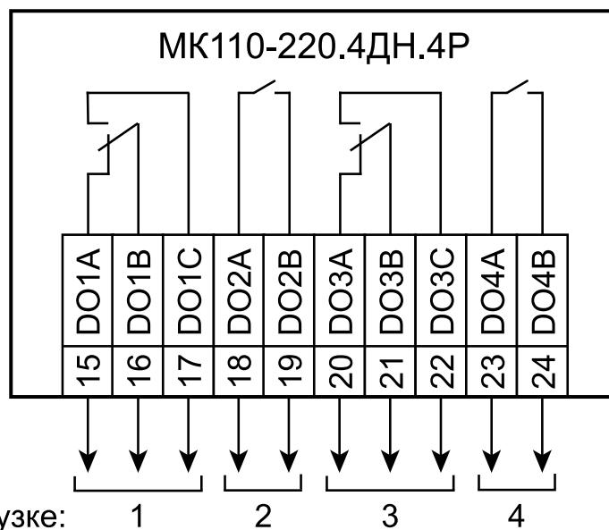
Рисунок 5.3 – Схема подключения к выходу типа электромагнитное реле
