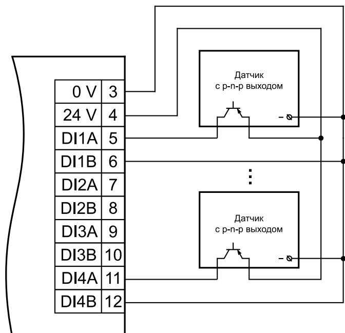
Рисунок 5.6 – Схема подключения дискретных датчиков с транзисторным выходом р-п-р типа
