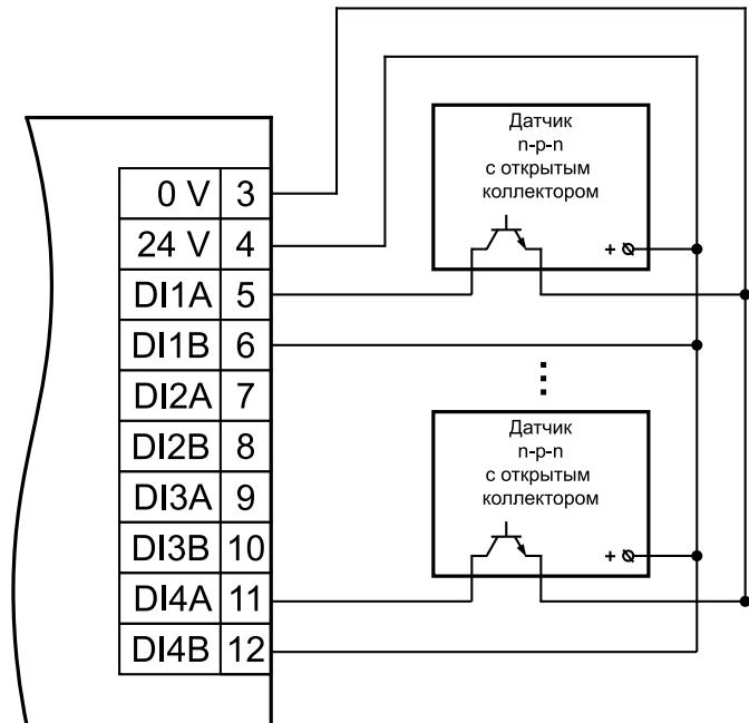
Рисунок 5.5 – Схема подключения дискретных датчиков с транзисторным выходом п-р-п типа с открытым коллектором
