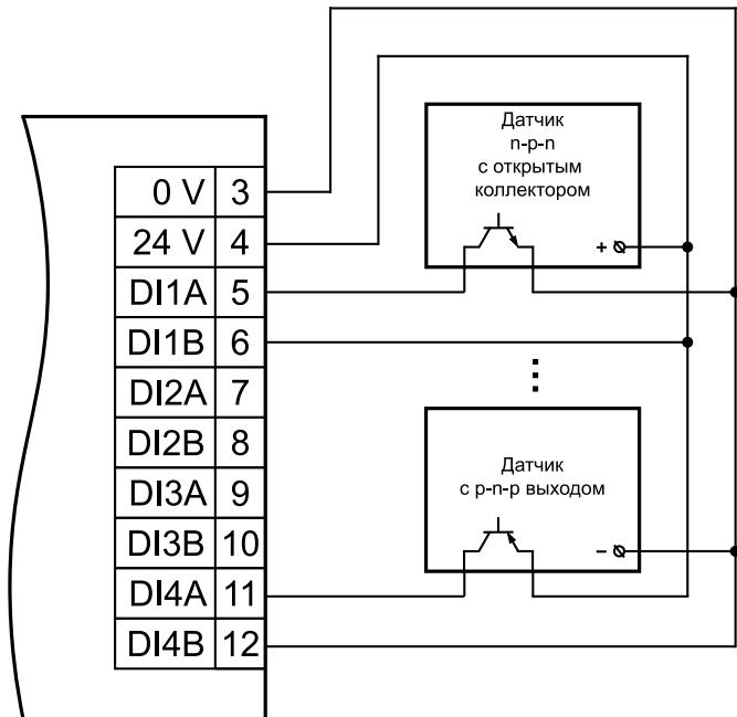
Рисунок 5.7 – Схема подключения дискретных датчиков с транзисторным выходом p-n-p типа и n-p-n типа с открытым коллектором
