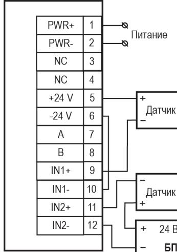
Рисунок 2 – Подключение к прибору двухпроводных датчиков
