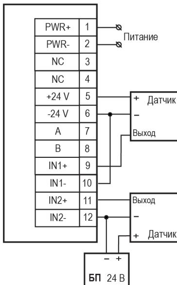
Рисунок 3 – Подключение к прибору трехпроводных датчиков
