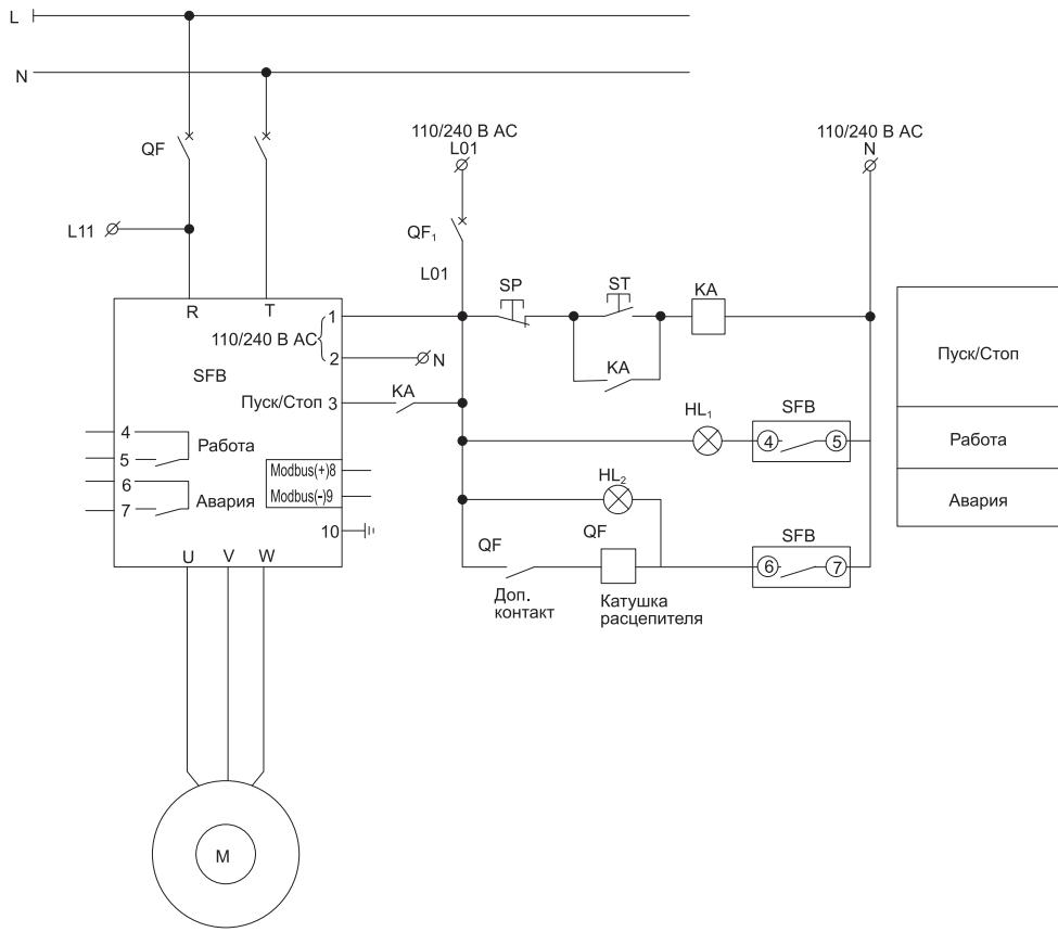
Рисунок Б.3 — Пример схемы подключения однофазного УПП с платой управления с питанием 100÷240 В АС
