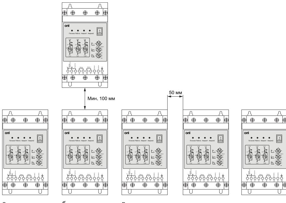
Рисунок 3 — Установка устройств: а) одиночная; б) групповая вертикальная;
