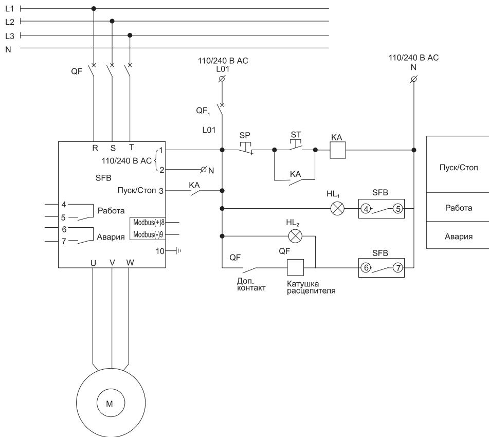
Рисунок Б.1 — Пример схемы подключения трехфазного УПП с платой управления
