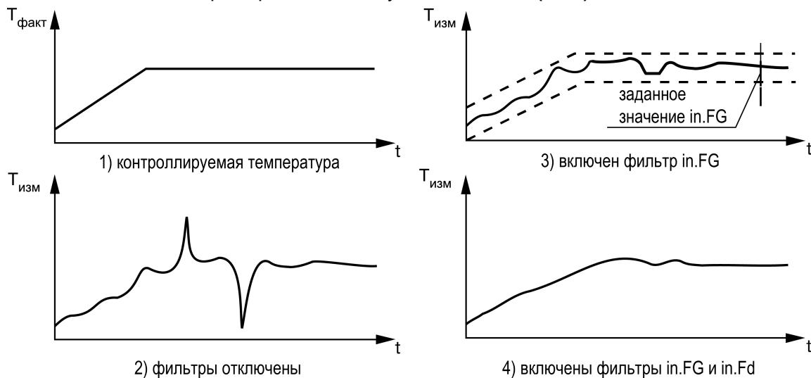
Рисунок 7.7 – Временные диаграммы работы цифровых фильтров
