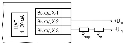
**Рисунок 5.17 – Схема подключения нагрузки к ВУ типа И**
