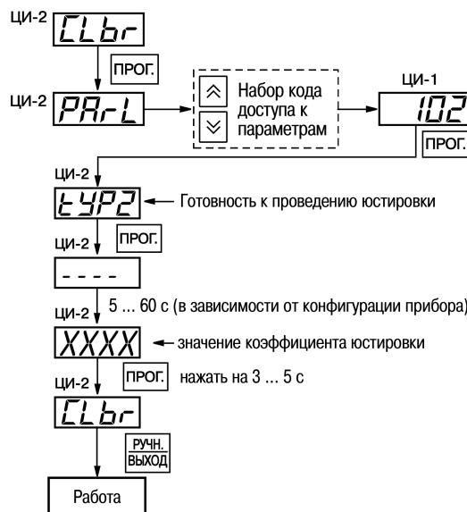
**Рисунок 8.4 – Схема проведения юстировки датчика свободных концов ТП**
