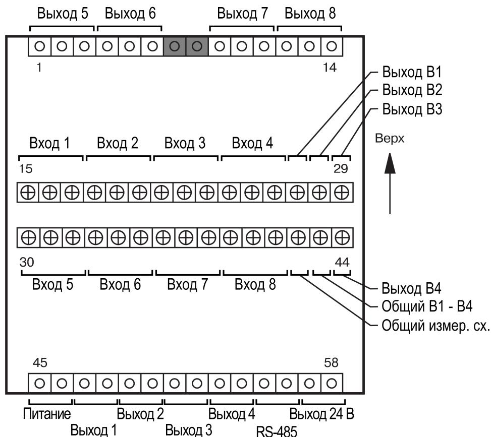
Рисунок 5.2 – Клеммник TPM138B
