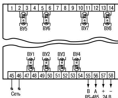
Рисунок 5.16 – Схема подключения симисторных оптопар прибора
