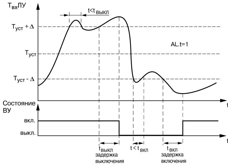
**Рисунок 7.12 – Работа ЛУ с задержками включения и выключения**
