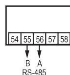
**Рисунок 5.18 – Схема подключения для интерфейса RS-485**
