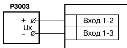
**Рисунок 8.5 – Схема подключения компаратора напряжения при юстировке**
