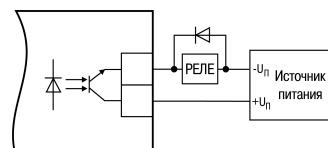
**Рисунок 5.12 – Схема подключения нагрузки к ВУ типа К**
