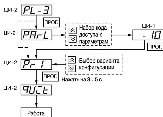
Рисунок 7.5 – Схема настройки параметров на уровне PL-3
