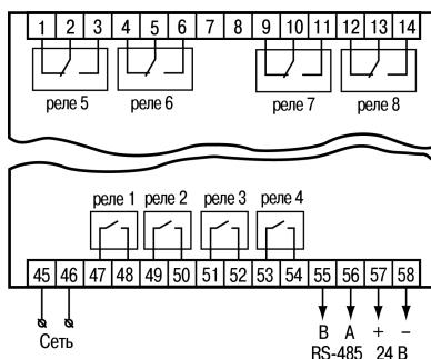
**Рисунок 5.11 – Схема подключения электромагнитных реле прибора**
