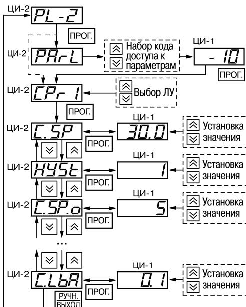
Рисунок 7.4 – Схема настройки параметров на уровне PL-2
