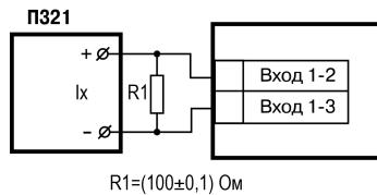
**Рисунок 8.6 – Схема подключения калибратора тока при юстировке**
