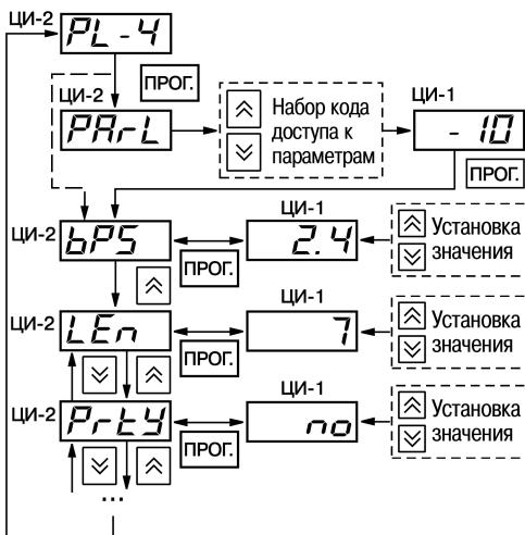
**Рисунок 7.6 – Схема настройки параметров на уровне PL-4**
