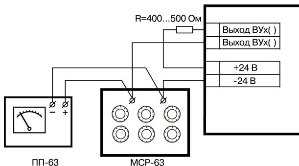
**Рисунок 8.7 – Схема подключения аппаратуры при юстировке ЦАП**
