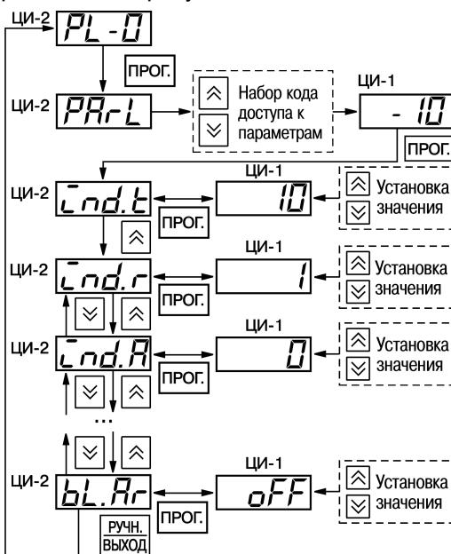
**Рисунок 7.2 – Схема настройки параметров на уровне PL-0**
