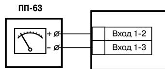
**Рисунок 8.3 – Схема подключения потенциометра при юстировке**
