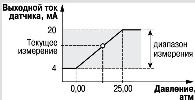
**Рисунок 4.2 – Пример задания диапазона измерения**
