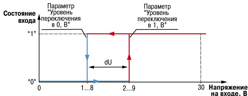
**Рисунок 4.3 – Работа универсального входа в дискретном режиме**
