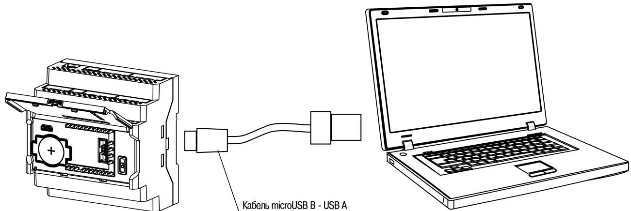
Рисунок 6.9 – Подключение к ПК (крышка открыта)
