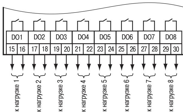
**Рисунок 6.6 – Схема подключения нагрузки к ВЭ типа «Р»**
