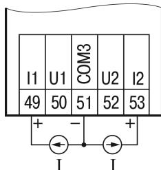
**Рисунок 6.4 – Подключение активного датчика с выходом типа «Ток 4...20 мА»**
