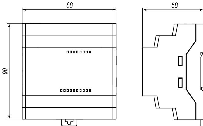
**Рисунок 5.1 – Габаритные размеры**
