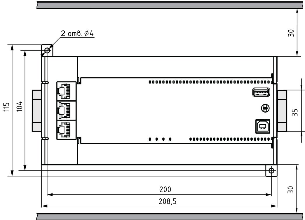
Рисунок 5.3 – Расстояние до стенок корпуса прибора во время монтажа для обеспечения вентиляции
