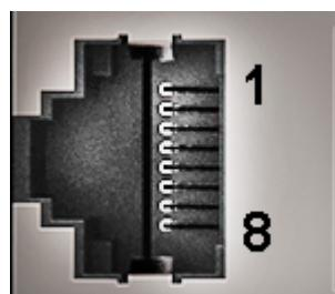
**Рисунок 3.4 – Порт RS-232 Debug****Таблица 3.9 – Назначение контактов порта RS-232 Debug**
