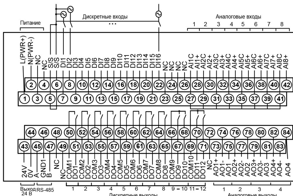
Рисунок 6.1 – Схема расположения и назначение клемм на приборе
