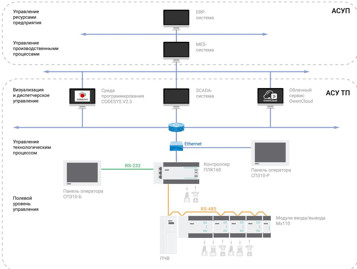
Рисунок 6.12 – Пример комплексной архитектуры системы управления
