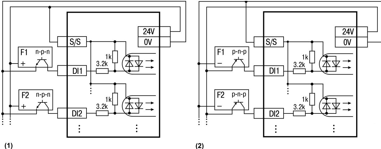
Рисунок 6.3 – Подключение к дискретным входам датчиков ( $F_1–F_n$ ), имеющих на выходе транзисторный ключ п-р-п-типа (1) и р-п-р-типа (2)
