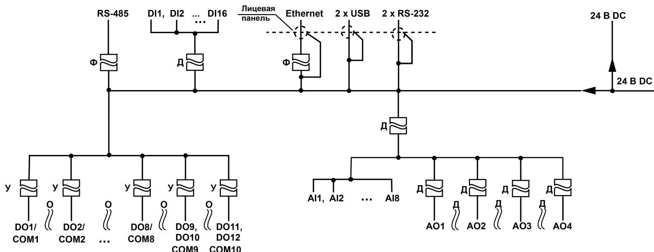
Рисунок 2.2 – Схема электрической прочности изоляции ПЛК160-24.Х-М(М02)
