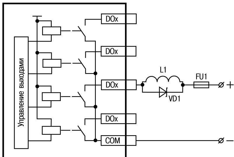
Рисунок 6.5 – Подключение цепей защиты при реактивной нагрузке
