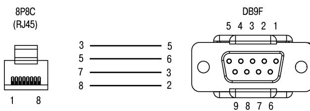
Рисунок 6.9 – Схема кабеля KC16
