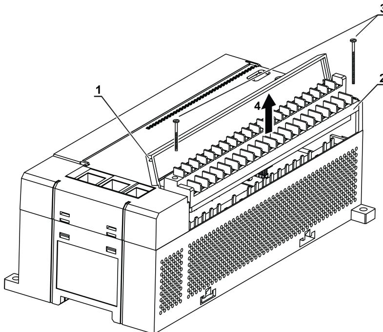
**Рисунок 3.5 – Отсоединение клемм**
