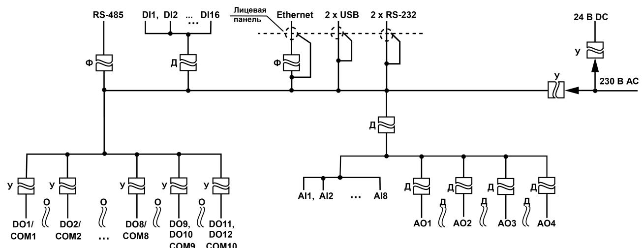
**Рисунок 2.1 – Схема электрической прочности изоляции ПЛК160-220.Х-М(М02)**
