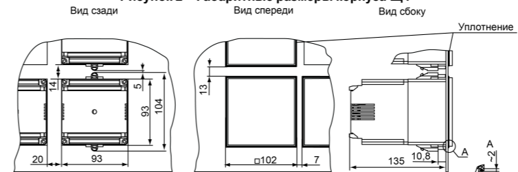
Рисунок 3 – Прибор в корпусе Щ4, установленный в щит толщиной 3 мм
