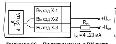
Рисунок 28 – Подключение к ВУ типа «И»
