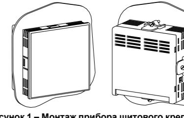
Рисунок 1 – Монтаж прибора щитового крепления Щ1
