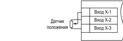
Рисунок 22 – Подключение датчика положения резистивного типа
