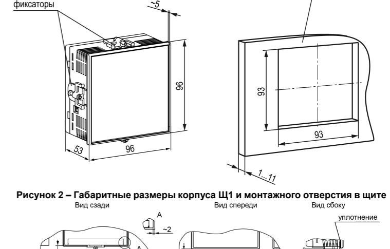
Рисунок 2 – Габаритные размеры корпуса Щ1 и монтажного отверстия в щите
