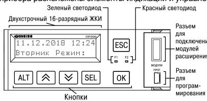
Рисунок 10 – Лицевая панель прибора (крышка отсека подключения модулей условно не показана)
