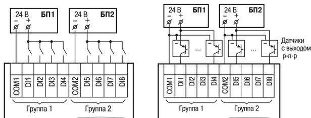
Рисунок 6 – Подключение дискретных датчиков с питанием 24 В
