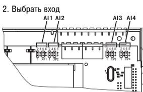
Рисунок 4 – Схема настройки AI1...AI4
