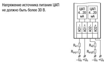
Рисунок 9 – Подключение нагрузки к ВЭ типа «И»
