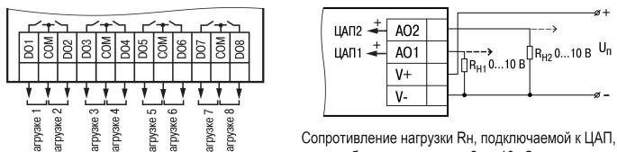
Для коммутации силовых цепей напряжением не более 250 В переменного тока и рабочим током не более 5 А.
