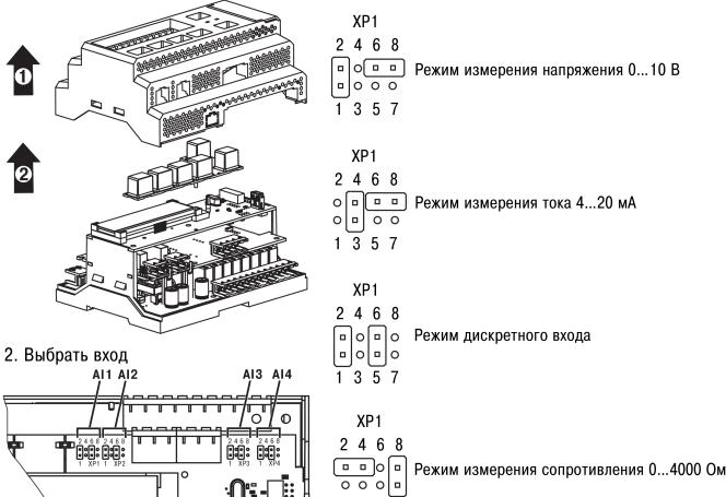
Рисунок 4 – Схема настройки AI1...AI4
