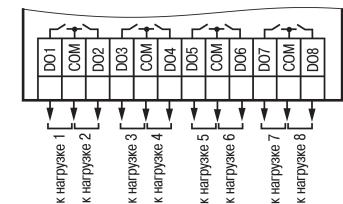
Для коммутации силовых цепей напряжением не более 250 В переменного тока и рабочим током не более 5 А.
