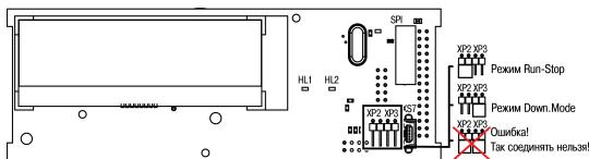
Рисунок 5 – Вид на верхнюю плату со снятой крышкой
