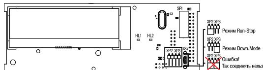
Рисунок 5 – Вид на верхнюю плату со снятой крышкой
