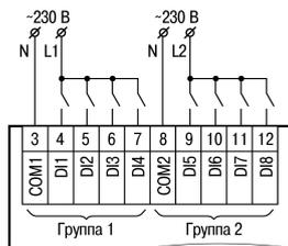
Рисунок 5 – Подключение дискретных датчиков с питанием 230 В
