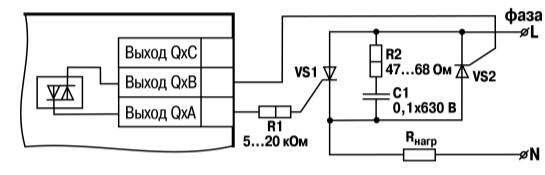
Рисунок 13 – Схема подключения к ВУ типа «С» двух триисторов, подключенных встречно-параллельно
