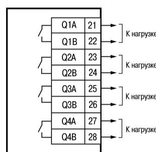
Рисунок 8 – Схема подключения нагрузки к выходным реле Q1–Q4
