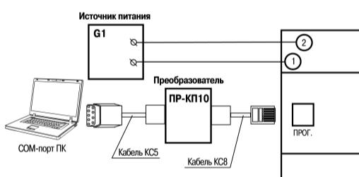
Рисунок 16 – Схема подключения к ПК (через преобразователь ПР-КП10)
