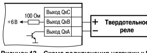
Рисунок 12 – Схема подключения нагрузки к ВЭ типа «Г»
