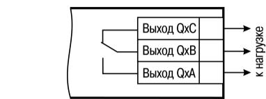
Рисунок 9 – Схема подключения нагрузки к ВЭ типа «Р»
