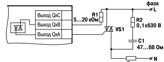
Рисунок 11 – Схема подключения силового триистора к ВЭ типа «С»
