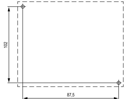
Рисунок 2 – Разметка для монтажа на стену
