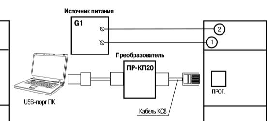
Рисунок 17 – Схема подключения к ПК (через преобразователь ПР-КП20)
