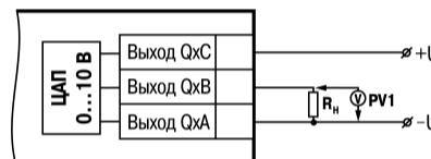
Рисунок 14 – Схема подключения нагрузки к ВЭ типа «У»
