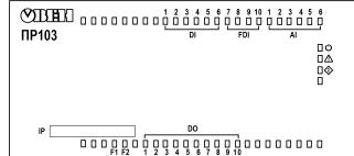
Рисунок 8 – Пример лицевой панели прибора
