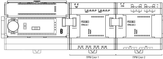
Рисунок 7 – Расположение модулей расширения на шине
