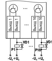
Рисунок 4 – Схема подключения нагрузок к ВЭ типа «К»
