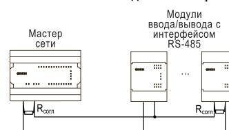
Рисунок 6 – Типовая схема подключения в режиме Master
