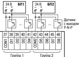
Рисунок 5 – Подключение датчиков с выходным транзистором p-n-p-типа
