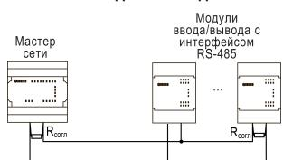
Рисунок 10 – Типовая схема подключения для ПР100 в режиме Master
