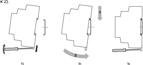
Рисунок 1 – Установка прибора
