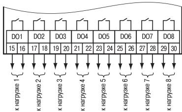
Рисунок 8 – Схема подключения нагрузки к ВЭ типа «Р»
