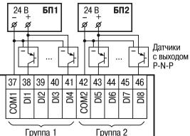
Рисунок 5 – Подключение датчиков с выходным транзистором р-п-р-типа
