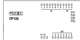
Рисунок 9 – Лицевая панель прибора
