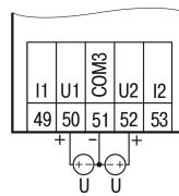
Рисунок 7 – Подключение активных датчиков с выходом типа «Напряжение 0...10 В»
