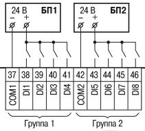
Рисунок 4 – Подключение дискретных датчиков с питанием 24 В
