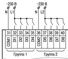
Рисунок 4 – Подключение дискретных датчиков с питанием 230 В
