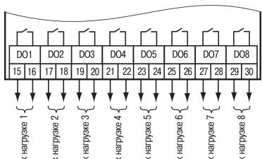
Рисунок 5 – Схема подключения нагрузки к ВЭ типа «Р»
