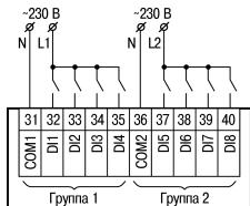
Рисунок 4 – Подключение дискретных датчиков с питанием 230 В
