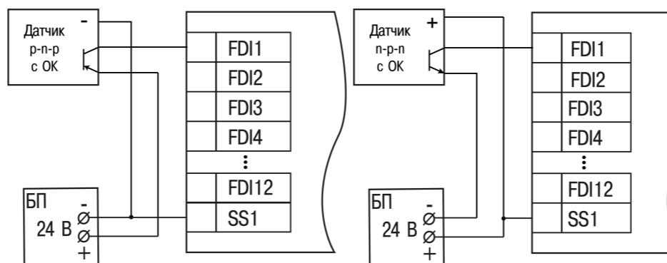
Рисунок 6 – Подключение транзисторов типа p-n-p
