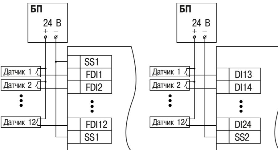
Рисунок 4 – Схема подключения контактных датчиков к дискретным входам FDI1–FDI12
