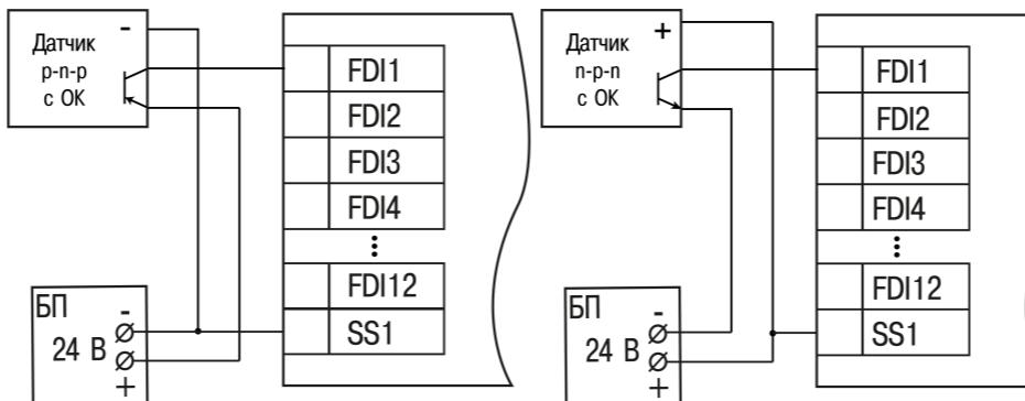
Рисунок 6 – Подключение транзисторов типа n-p-n
