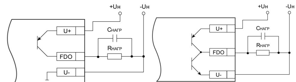
Рисунок 8 – Схема подключения нагрузки в режиме включения «верхний ключ»
