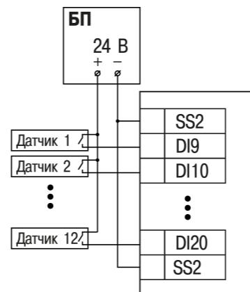
Рисунок 5 – Схема подключения датчиков к дискретным входам DI9–DI20
