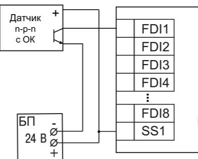
Рисунок 7 – Подключение транзисторов типа n-p-n
