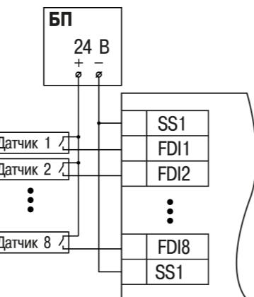
Рисунок 4 – Схема подключения датчиков к быстрым дискретным входам FDI1–FDI8
