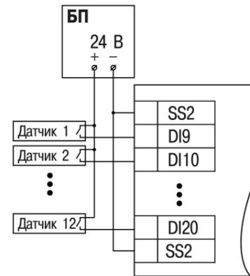
Рисунок 5 – Схема подключения датчиков к дискретным входам DI9–DI20
