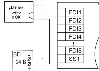
Рисунок 6 – Подключение транзисторов типа p-n-p
