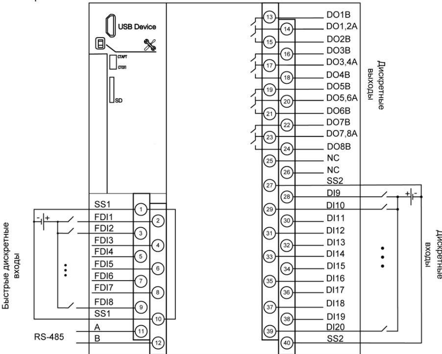
Рисунок 3 – Назначение контактов клеммника
