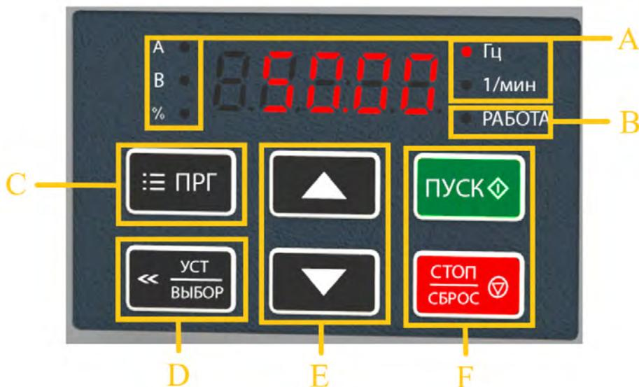
Панель управления преобразователя частоты
