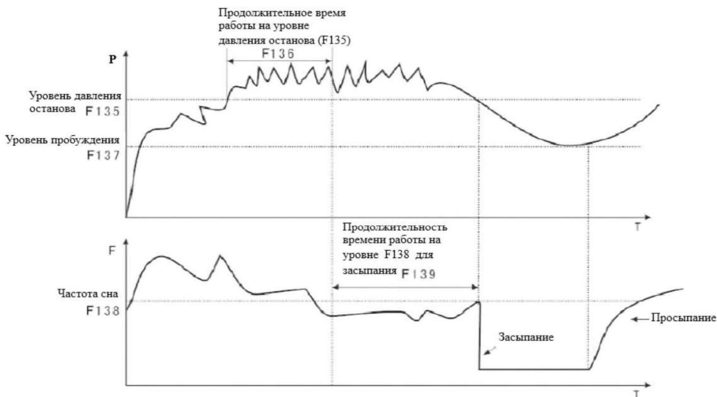
Рисунок 6-16 Настройка основного насоса и временная диаграмма
