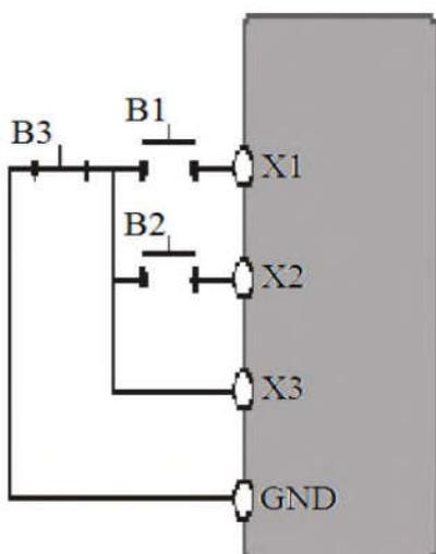
Рисунок 6-7 Трехпроводная схема подключения
