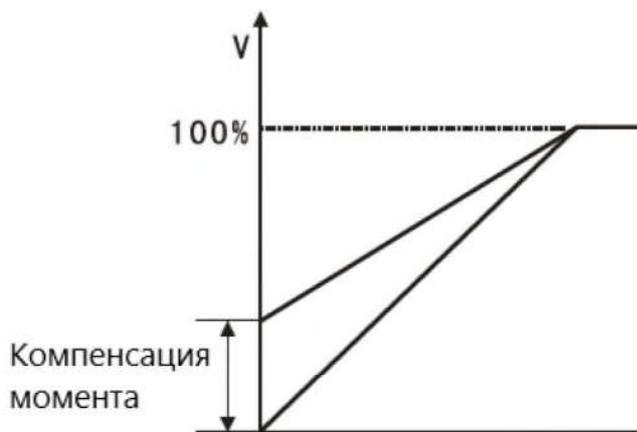
Рисунок 6-17 Автоматическая компенсация крутящего момента
