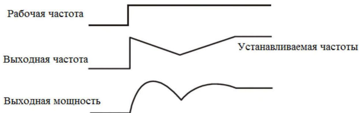
Рисунок 6-3 Запуск с отслеживанием частоты
