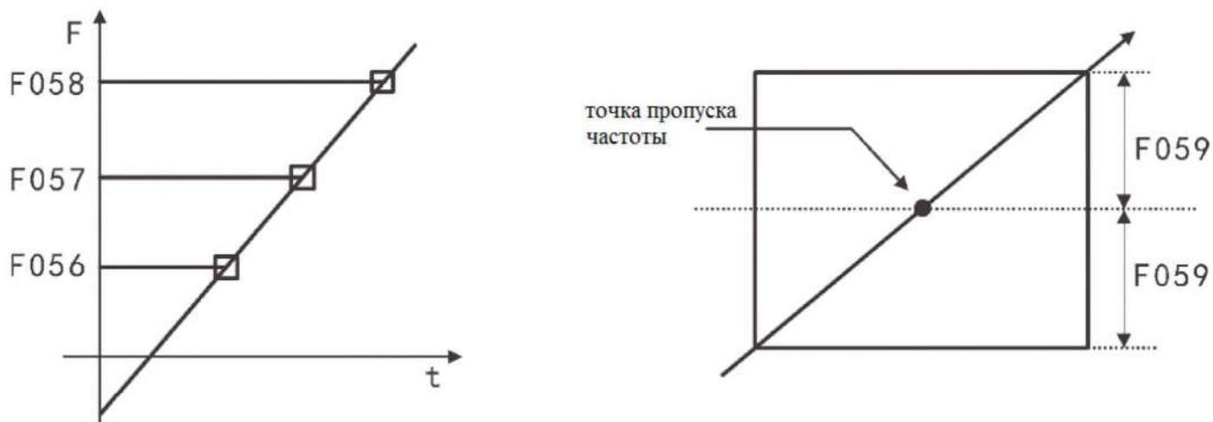
Рисунок 6-10. Пропускание частоты
