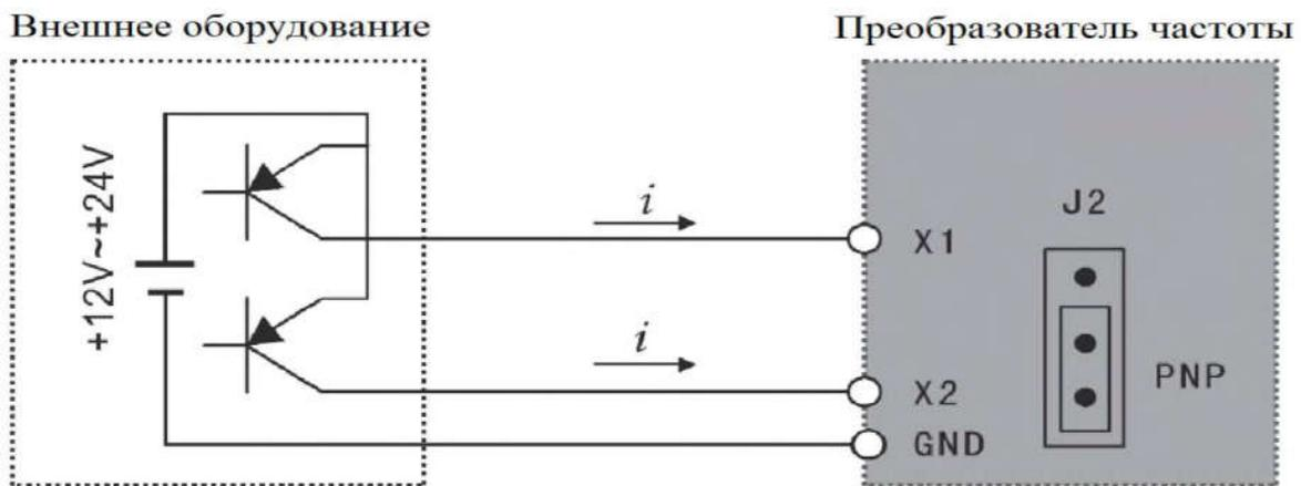
Рисунок 3-2. Тип подключения PNP
