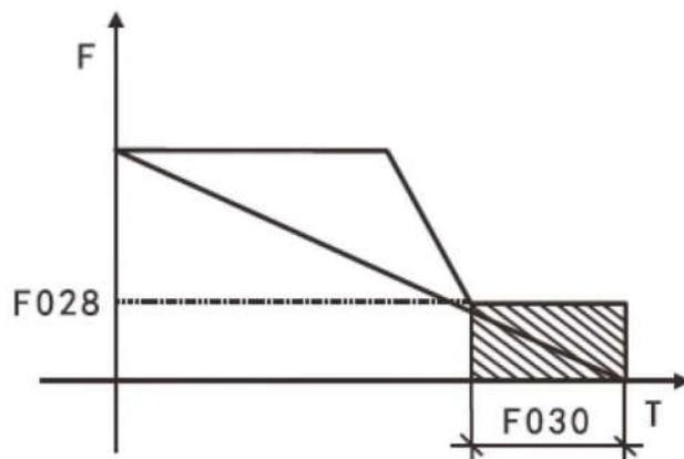
Рисунок 6-5 Время торможения постоянным током при остановке
