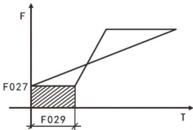
Рисунок 6-4 Время торможения постоянным током при запуске
