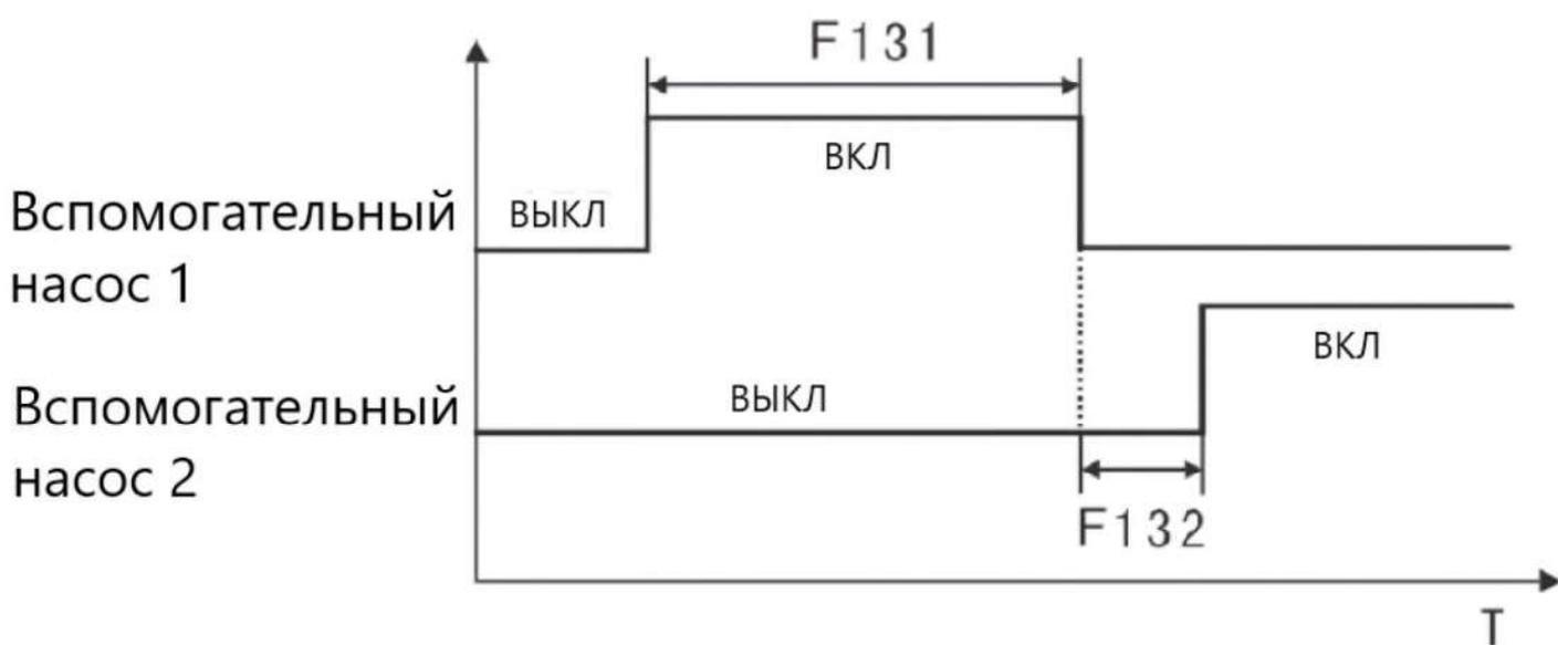
Рисунок 6-14. Переключение времени блокировки вспомогательного насоса
