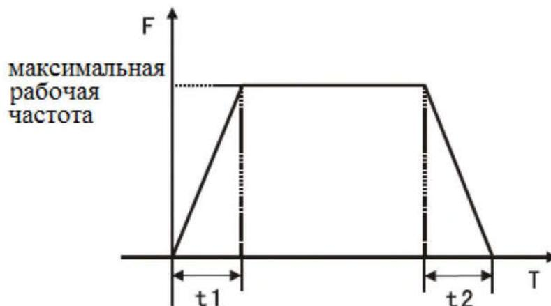
Рисунок 6-2 Кривые времени ускорения / замедления
