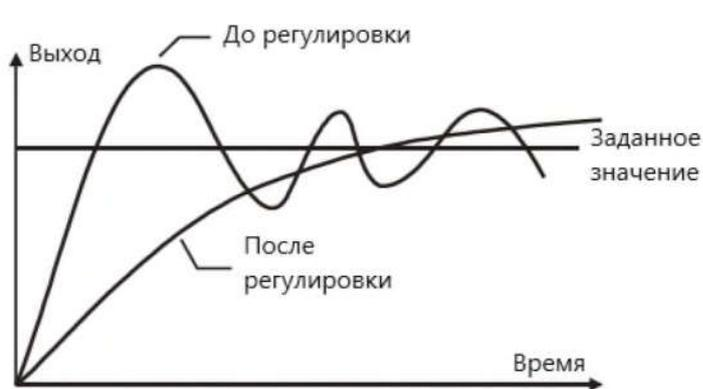
Рисунок 6-20. Подавление колебаний на выходе ПИД-регулятора
