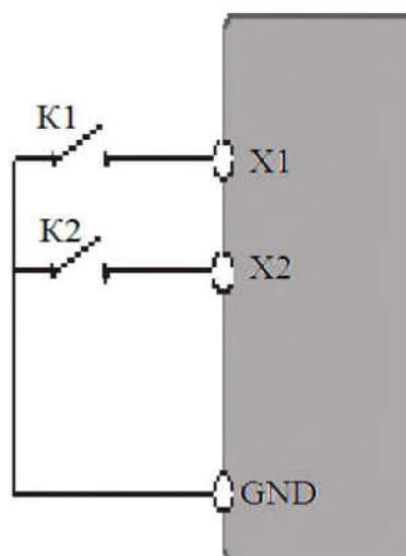
Рисунок 6-8 Двухпроводная схема подключения
