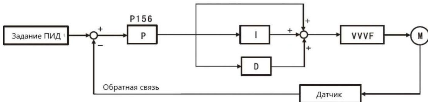
Рисунок 6-18 Блок-схема ПИД-регулятора
