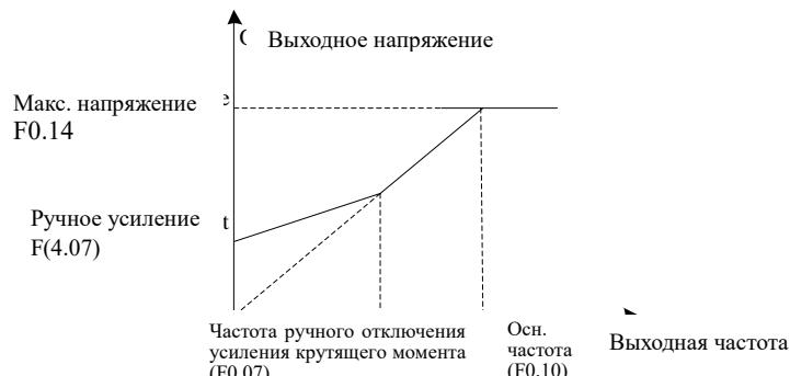
Рис.6-10 Схема усиления крутящего момента
