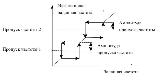
Рис. 6-5 Пропуск частот
