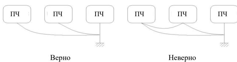
Рис. 3-5 Заземление
