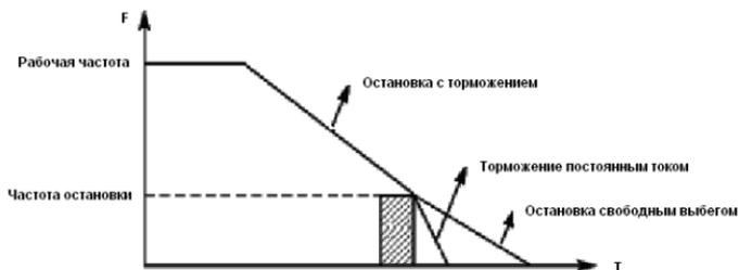
Когда торможение постоянным током неактивно, ПЧ уменьшает частоту вращения до тех пор, пока не будет достигнута частота останова; ПЧ прекращает вывод частоты и двигатель свободно вращается до полной остановки.
