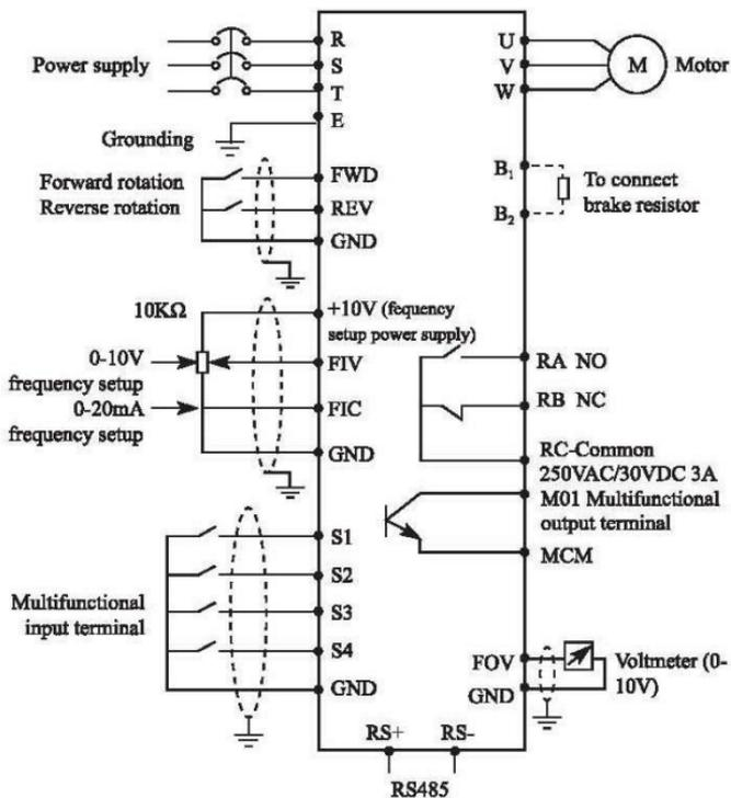
4-2-2 Клеммы терминала управления.
