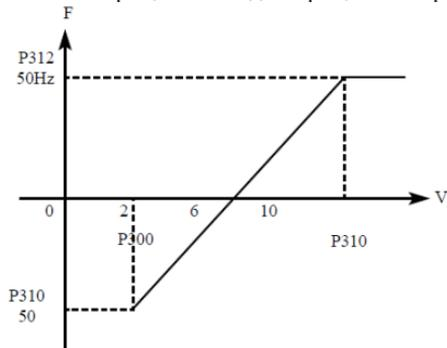
Примечание: P300=2, минимальное входное напряжение на входе AV: 2V (сигнал с напряжением ниже 2V считается равным нулю);
