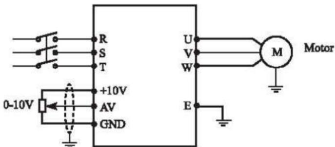
Примечание: 0-10V сигнал непосредственно введен через AV (AV) , чтобы управлять рабочей частотой преобразователя частоты.
