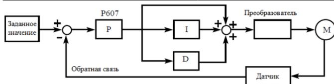
При использовании PI или PID – законов регулирования допускается возможность возникновения ошибки регулирования с величиной до  $\pm 10\%$  от значения максимального сигнала обратной связи. Допустимая ошибка определяется величиной параметра P620.
