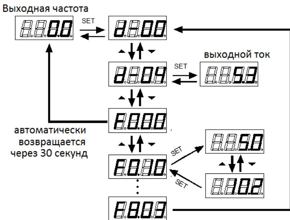
После установки параметра возвращаемся в мониторинг частоты:
