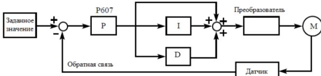
При использовании PI или PID – законов регулирования допускается возможность возникновения ошибки регулирования с величиной до  $\pm 10\%$  от значения максимального сигнала обратной связи.
