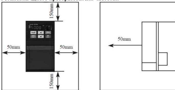
**Установка нескольких преобразователей частоты в одном шкафе:**
