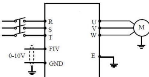
Примечание: 0-10V сигнал непосредственно введен через F1V, чтобы управлять рабочей частотой преобразователя частоты.
