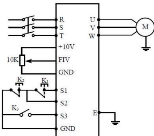
Настройка параметра P533 определяющего направления вращения.
