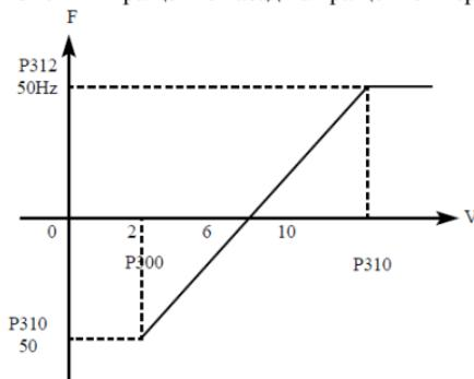
Примечание: P300=2, минимальное входное напряжение на входе FIV: 2V (сигнал с напряжением ниже 2V считается равным нулю);
