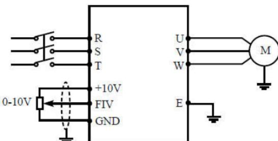
Примечание: сигнал напряжения F1V введен через внешний потенциометр (10 КΩ), чтобы управлять рабочей частотой преобразователя частоты.
