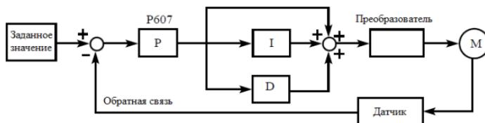
Замечания по использованию преобразователя в режиме PID-регулирования:
