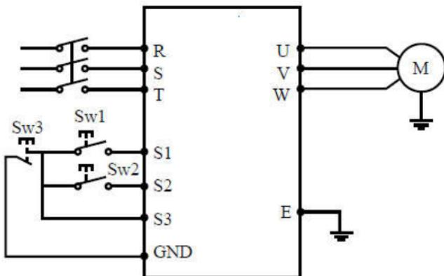
В качестве входов для внешнего сигнала здесь используются Sw1, Sw2, и Sw3. Контакт Sw3 нормально замкнутый. S1, S2 и S3 отобраны как входные терминалы для внешнего сигнала. Параметр: P317=6, прямое управление назначено на S1
