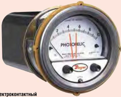
Электроконтактный манометр Photohelic® серии A3000
