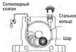
**Пневматические роликовые вибраторы серии PRV** имеют высокую частоту вибрации, которая может предотвращать создание заторов для материала при его движении в трубе. Также они могут быть использованы для разрушения заторов или при операциях, связанных с подачей бетона.
