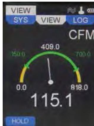
Подобен измерительному режиму с дополнительной программируемой зеленой полосой для быстрой визуальной оценки текущего состояния приемки или браковки
