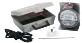
**Комплект принадлежностей для воздушного фильтра А-605** позволяет приспособить любой стандартный манометр Magnehelic® для измерения давления на воздушном фильтре. Включает в себя алюминиевый кронштейн для крепления на поверхности с винтами, две алюминиевые трубки длиной 1,5 м, два наконечника для измерения статического давления и два литых пластиковых клапана со встроеными обжимными фитингами.
