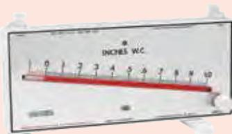
Модель №40-1 наклонного манометра Mark II
