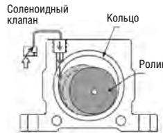
**Пневматические турбинные вибраторы серии PTV** являются наилучшим выбором из маломощных вибраторов высокочастотных типов. Они обычно устанавливаются на вибрационном сепараторе, конвейере, автоматической монтажной машине, упаковочной или расфасовочной машине.
