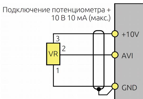
Рис. 3 Подключение потенциометра.
